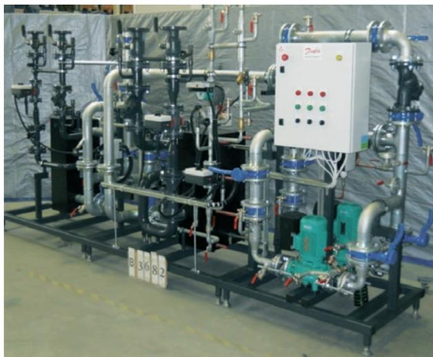
Рис. 36. БТП Danfoss с пластинчатыми теплообменниками.
