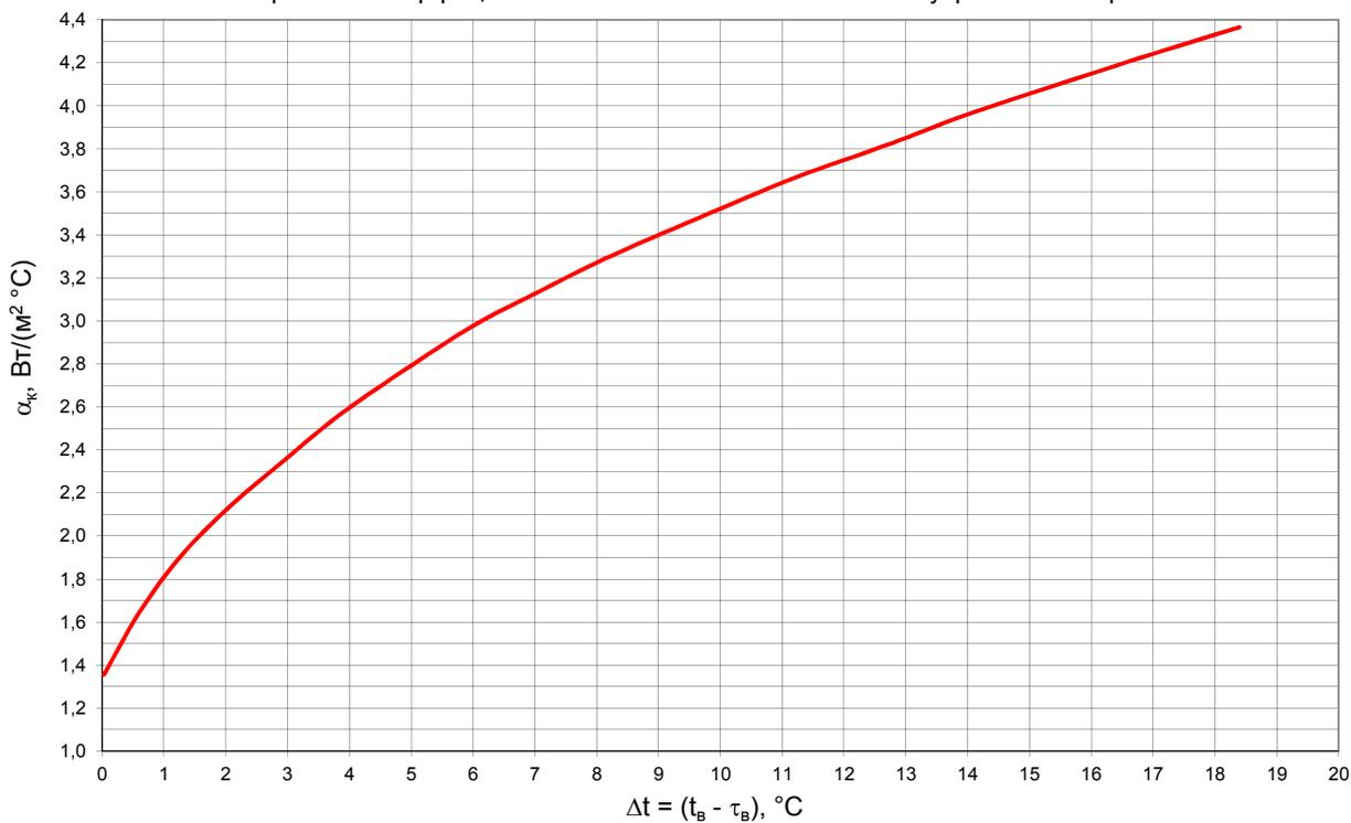
Чертеж 2. Коэффициент лучистого теплообмена внутренней поверхности
