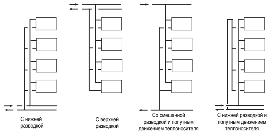
Рис. 9.11. Схемы размещения магистральных трубопроводов вертикальных систем отопления
