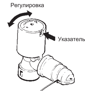
Рис. 9.4. Регулировка нейтральной зоны
