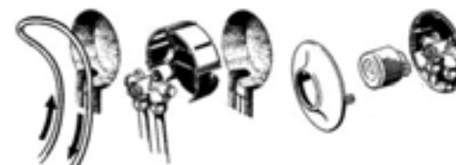
Рис. 9.21. Установка терморегулятора в петле змеевика системы напольного отопления
