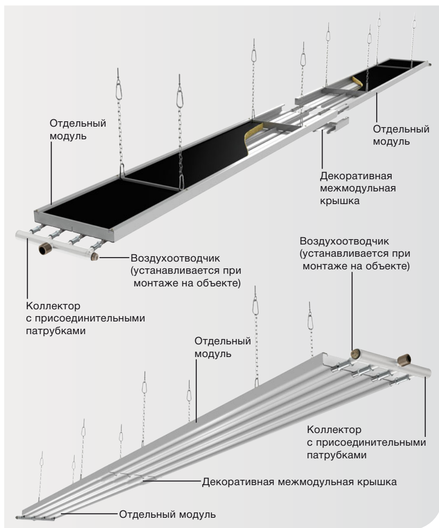
Рис. 3. Потолочная панель Zehnder 1ZIP в сборе
