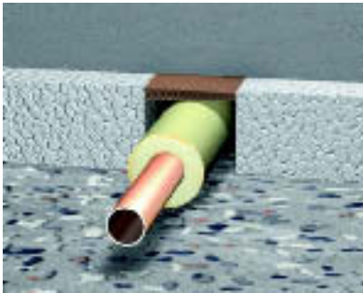
Рис. 4.36 Прокладка труб WICU®_extra по бетонному покрытию с выровненной поверхностью и выполненными зазорами для температурного удлинения
