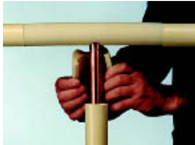
Рис. 4.28 Для изоляции тройниковых соединений диаметром до 28мм используются фасонные детали WICU® слева: раскрой фасонной детали справа: накладка фасонной детали
