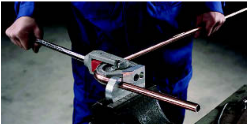
Рис. 4.17 Гибка с использованием инструмента
