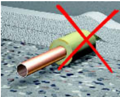
Рис. 4.37 Ошибки, возникающие при прокладке труб слева: труба создает выпуклость в изоляции справа: труба создает выпуклость в бесшовном полу
