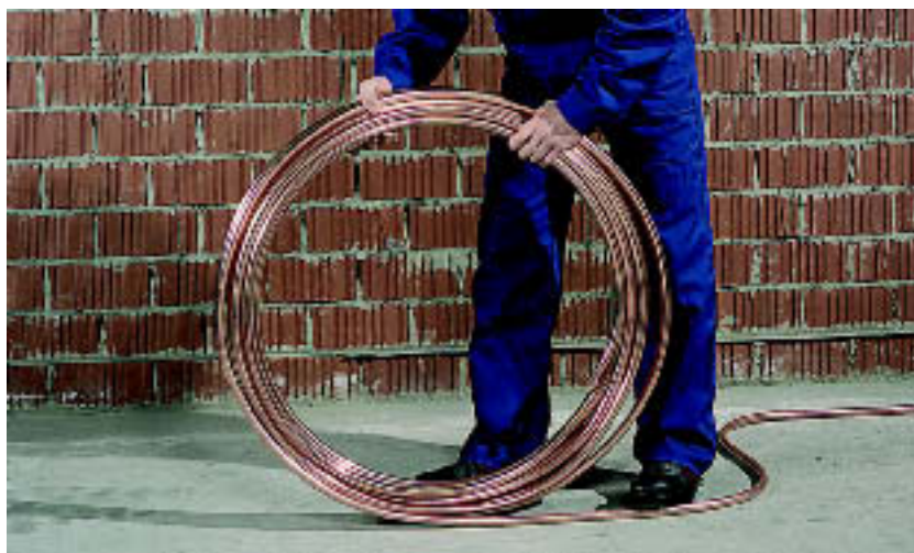
Рис. 4.16 Гибка без использования инструмента: разматывание бухты трубы SANCO ®
