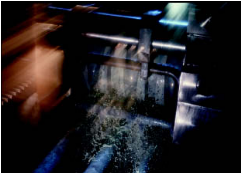
Рис. 2.11 Стан для прокатки трехручьевыми калибровочными валками
