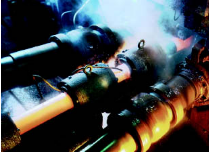
Рис. 2.10 Вид стана горячей поперечно-винтовой прокатки. Медные заготовки первоначальной длины 5,5 м перерабатываются на трубные заготовки длиной 12,5 м.
