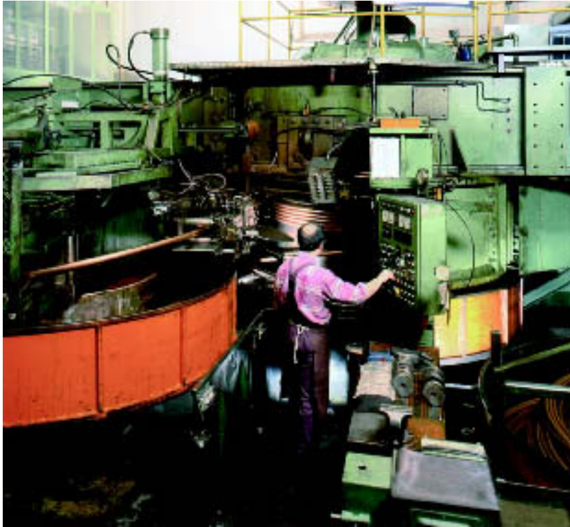
Рис. 2.12 Волочильный стан барабанного типа: при скорости волочения от 250 до 1000 м/мин, в зависимости от назначенных параметров, трубы могут получаться наружным диаметром от 6 до 50 мм.
