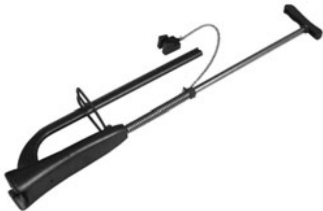
Оснастка для монтажа шпилек (анг. tackler)
