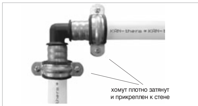
Выполнение точки неподвижной опоры рядом с отводом.
