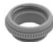
Адаптер M30x1,5 для электрического сервомотора ■ (серый цвет) - используется для термостатических вентилях, например, на подаче распределителя со смешивательной системой серии 73A и 77A
