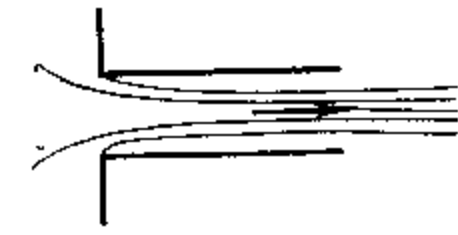
Фиг. 20-12. Схема истечения через насадок при срыве.
