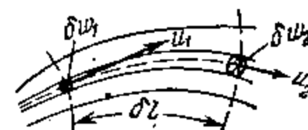
Фиг. 8-2. Схема элементарной струйки в неразрывном потоке.
