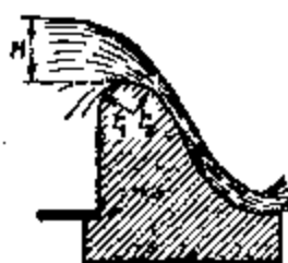
Фиг. 25-2. Водослив практического профиля, криволинейный, незатопленный.
