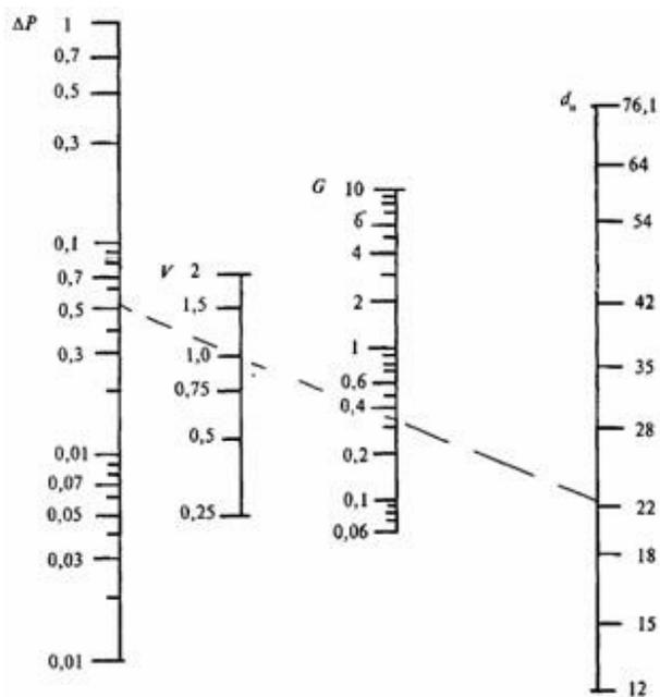
$d_n$  - наружный диаметр труб, мм;
