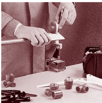
С помощью шаблона и графитного карандаша отметить на трубе глубину варки
