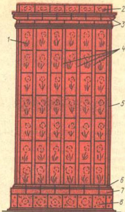
Рис. 170. Печь, облицованная крупноразмерной плиткой: 1...3, 6...8 — плитки, 4 — тавровый профиль, 5 — уголок
