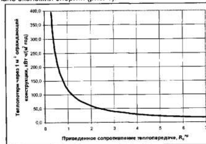
Рис. 1. Зависимость теплопотерь через 1 \text{ м}^2 ограждающей конструкции от приведенного сопротивления теплопередаче в условиях Москвы
