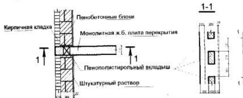
Рис. 1. Фрагмент несущей ограждающей конструкции здания
