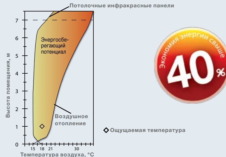
Рис. 2: Потолочные инфракрасные панели более экономичны по сравнению с системами воздушного отопления при одинаковой ощущаемой температуре.
