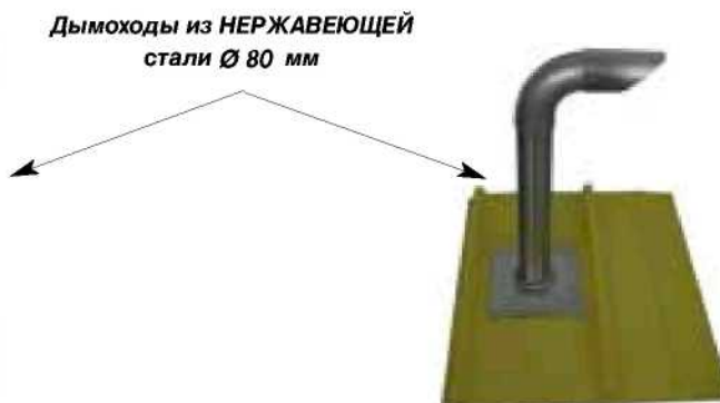
Рис. 34 На фото выше приведен фрагмент стыкового соединения дымохода и воздуховода (от прибора PANRAD) на кровле из профнастила. Каждое такое соединение выполняется по размерам с последующей гидроизоляцией.
