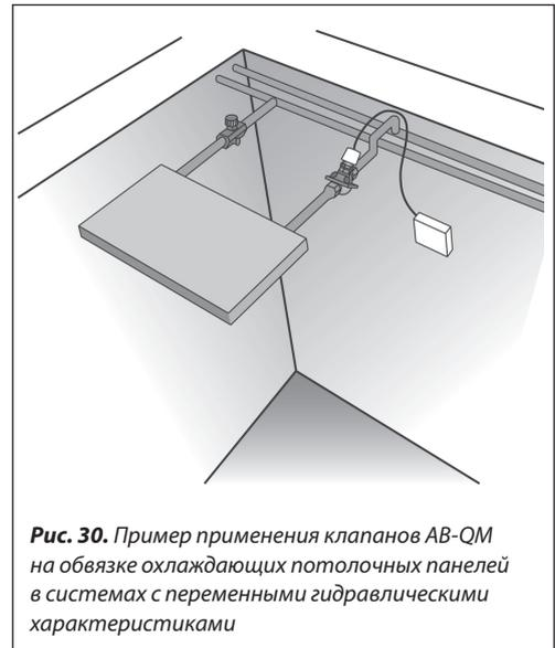
**Рис. 30.** Пример применения клапанов АВ-QM на обвязке охлаждающих потолочных панелей в системах с переменными гидравлическими характеристиками
