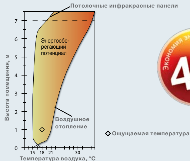
Рис. 2: Потолочные инфракрасные панели более экономичны по сравнению с системами воздушного отопления при одинаковой ощущаемой температуре.
