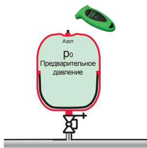
**Предварительное давление  $p_0$**  должно быть определено с учётом местных условий эксплуатации и записано на шильдике бака.
