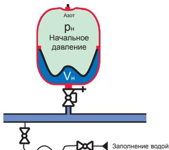
**Начальный запас  $V_n$**  создаётся при заполнении системы путём контролирования **начального давления  $p_n$**  по водяному манометру. После удаления воздуха и деаэрации системы пока не происходит разогрев значение  $p_n$  нужно ещё раз проконтролировать и, при необходимости, восстановить.
